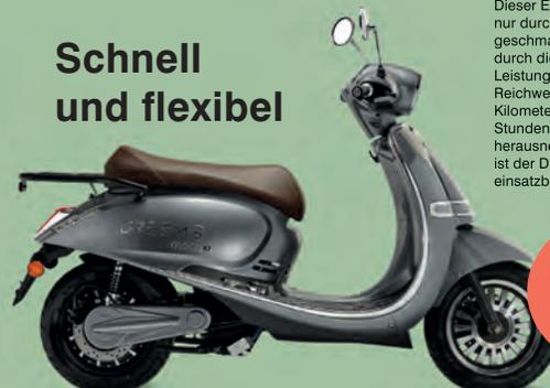
Dieser E-Roller begeistert nicht nur durch seine moderne und geschmackvolle Optik, sondern durch die außergewöhnliche Leistung von 5 kW und eine Reichweite von bis zu 105 Kilometer. Nach nur fünf Stunden Ladezeit des bequem herausnehmbaren 72 V Akku ist der DREEMS moon x wieder einsatzbereit.
